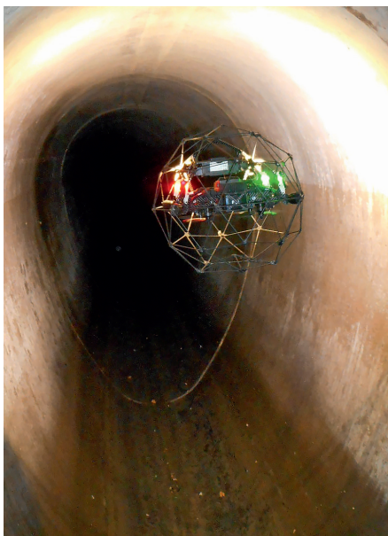
Markus Rockenschaub von Aerovision Drone Support fliegt mit seiner Drohne Elios 2 in schwer zugänglichem Indoor-Terrain.
